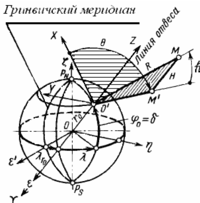
Рисунок 1.8 - Системы координат (геоцентрическая, топоцентрическая и инерциальная)
