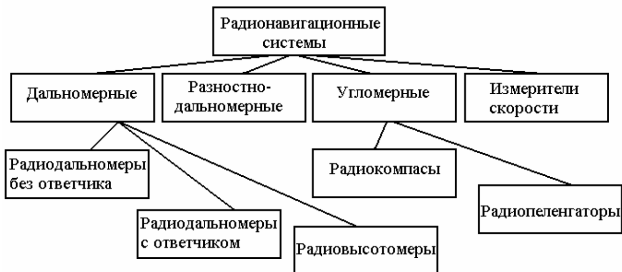
Рисунок 1.25 - Схема классификации радионавигационных устройств по навигационному параметру
